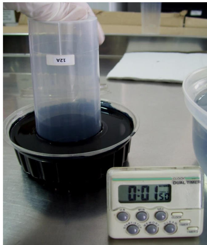
Figura 1. Sumersión del vaso en revelador SB.
