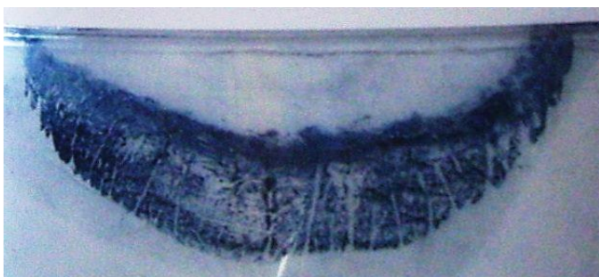
Figura 2. Resultado con revelador SB.
