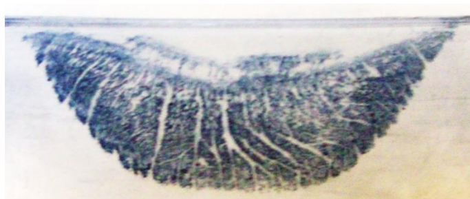
Figura 5. Cámaras de vaporizado con CA y posterior resultado con realzado de SB.
